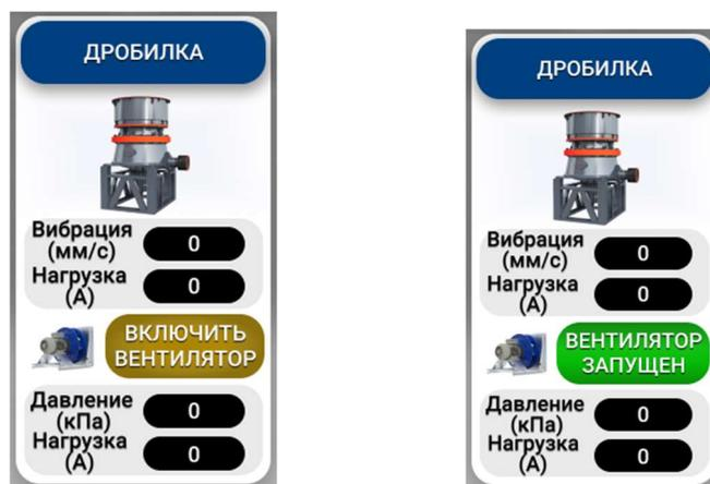
Рис. 7. Запрос на включение агрегата
