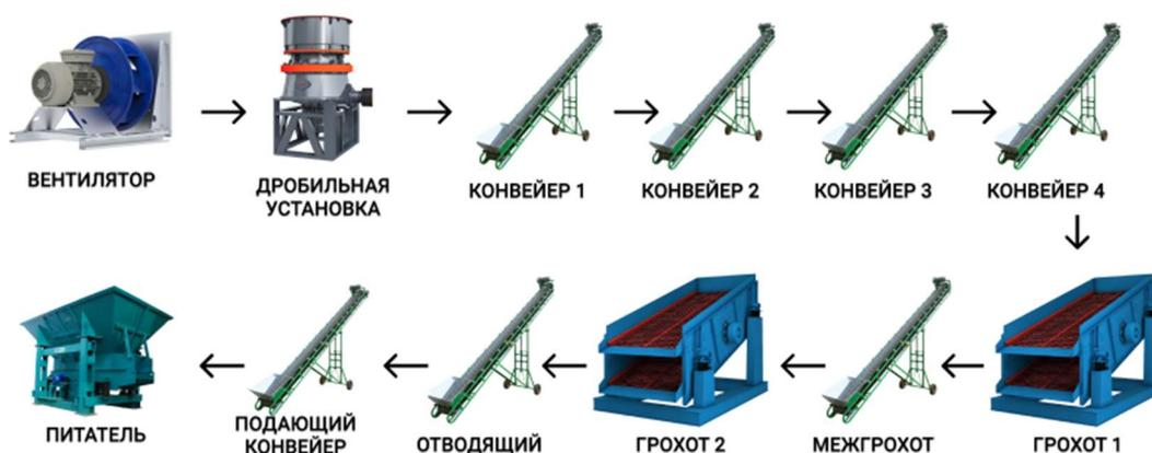
Рис. 6. Очередность запуска агрегатов в режиме работы
