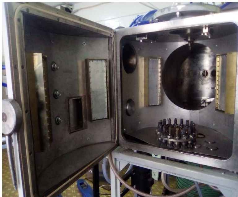
Рис. 1. Внешний вид и внутрикамерная оснастка установки магнетронного распыления Fig. 1. The view and in-chamber equipment of the magnetron sputtering facility
