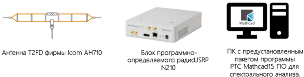
Рис. 2. Основные технические устройства для оценки спектра помех с разрешением 3, 6, 9, 12, 18, 24 кГц
