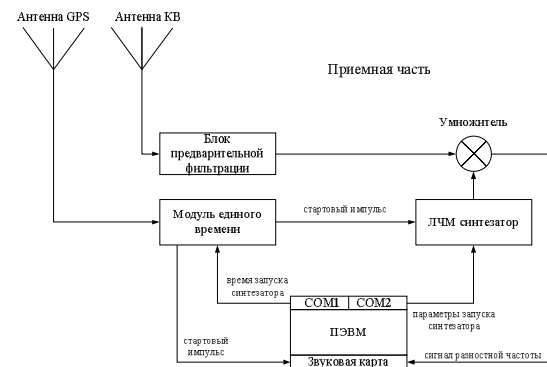
Рис. 2. Структурная схема приемной станции ЛЧМ-ионозонда
