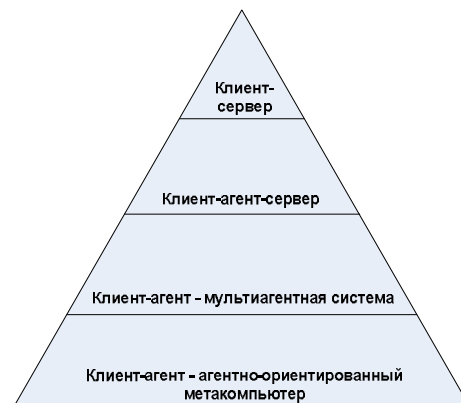
Рис. 2. Развитие сетевых агентно-ориентированных архитектур: от простой клиент-серверной архитектуры до агентно-ориентированной метакомпьютерной архитектуры облачного сервиса
