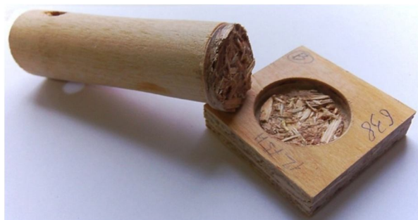
Рис. 5. Характерное разрушение образца фанеры при отрыве
