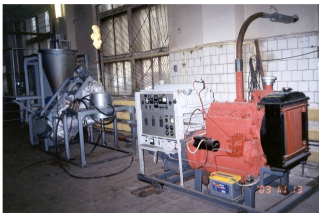
Рис. 2. Общий вид установки для получения жидкого и газообразного топлива (слева), производительность 0,5 т/сутки и дизель-генератор (справа) электрической мощностью 20 кВт
