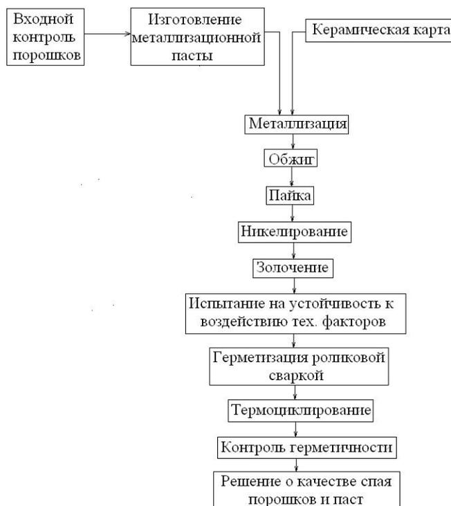
Рис. 2. Схема технологического опробования порошков
