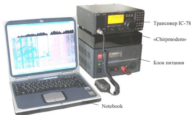
Рис. 1. Приемо-передающая станция ЛЧМ ионозонда
