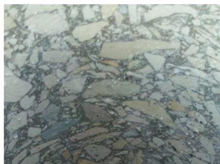
Рис. 1. Структура отсева дробления известнякового камня фр. 0 – 20 мм, укрепленного портландцементом совместно с ПМКН
