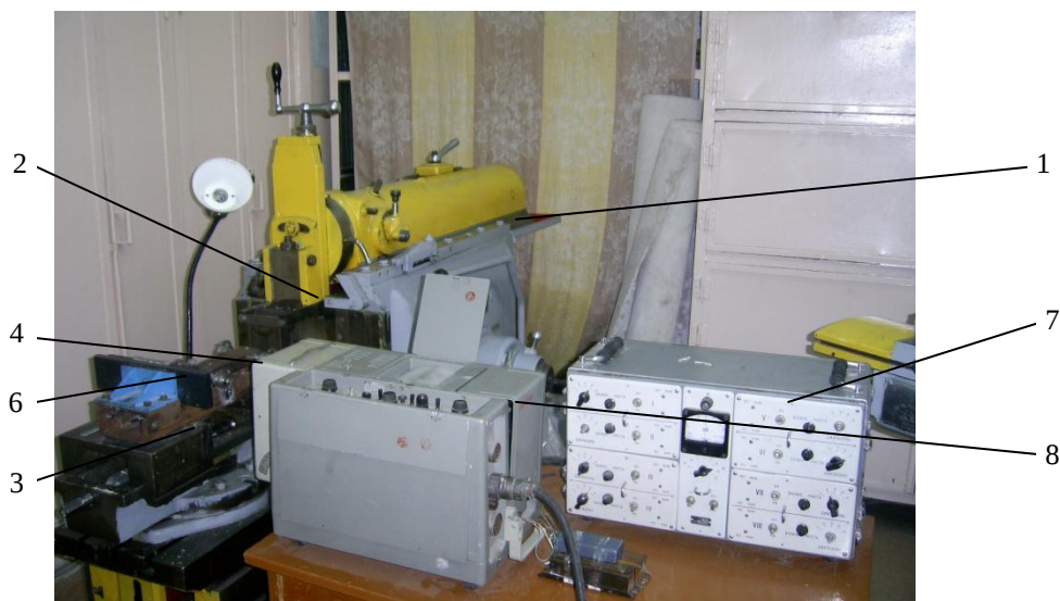
Рис. 1. Стенд для проведения экспериментов: 1 – горизонтально-строгольный станок; 2 – режущая головка; 3 – направляющая; 4 – каретка; 6 – тензометрическая балка; 7 – усилитель; 8 – осциллограф
