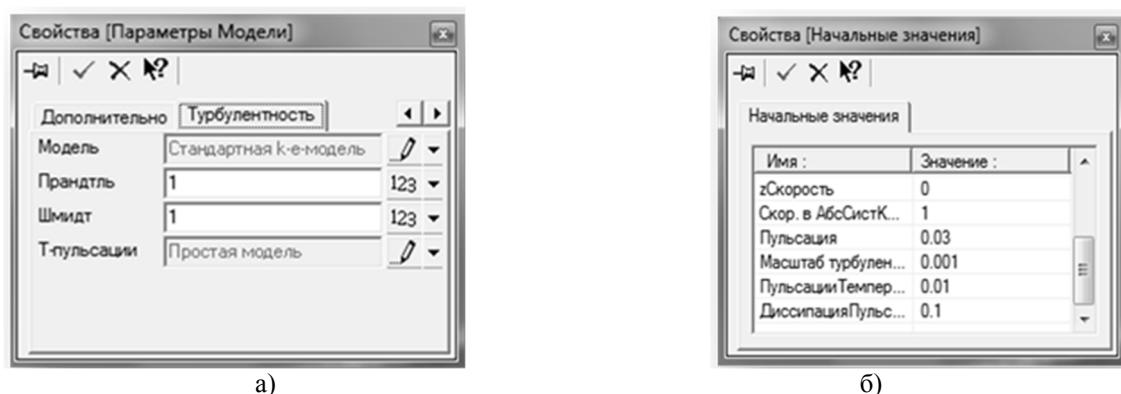
Рис. 5. Свойства модели турбулентности: а – параметры математической модели; б – начальные параметры моделирования
