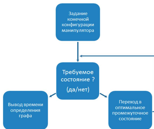
Рис. 2. Алгоритм работы системы контроля конфигурацией манипулятора
