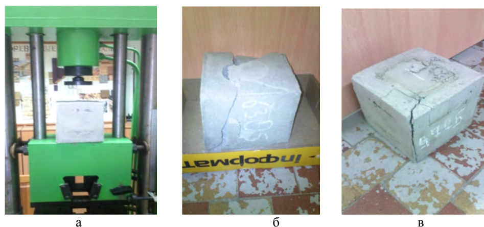
Рис. 3. Испытание сравниваемых образцов на прочность: а – гидравлический пресс; б – полнотелый блок; в – сквозной блок с «пустотелой коробкой»
