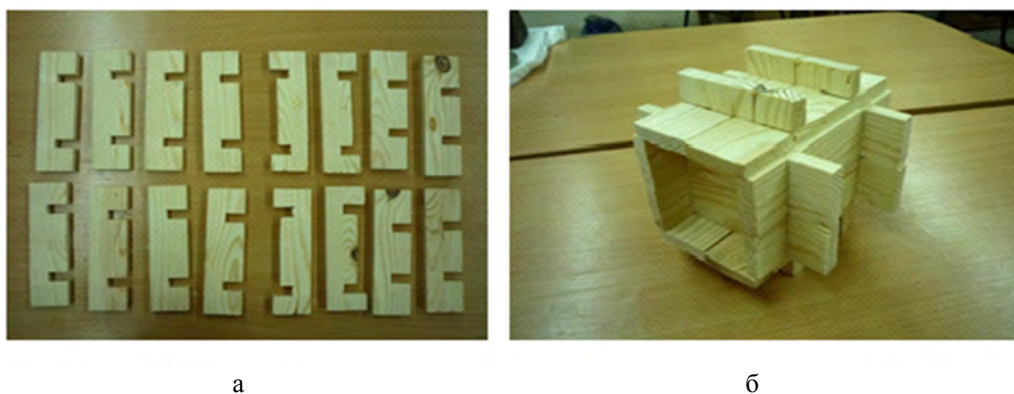
Рис. 1. Общий вид сборной коробки: а – элементы сборной коробки (деревянный стержень); б – деревянная коробка в сборе
