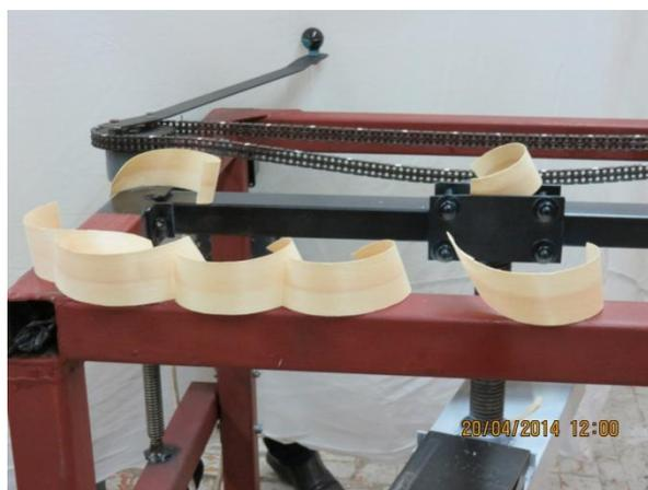
Рис. 5. Производимый шпон
