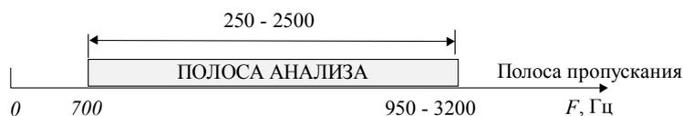
Рис.2. Полоса анализа сигнала разностной частоты
