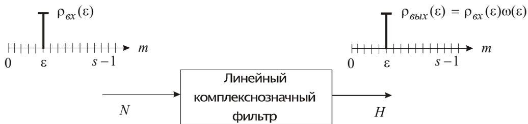
Рис.3. Прохождение через линейный фильтр монохроматического сигнала
