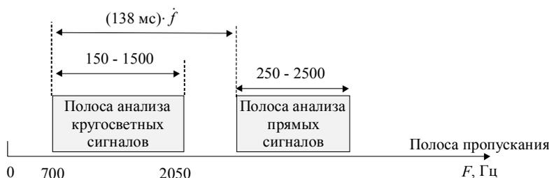
Рис.3. Полосы анализа прямых и кругосветных сигналов
