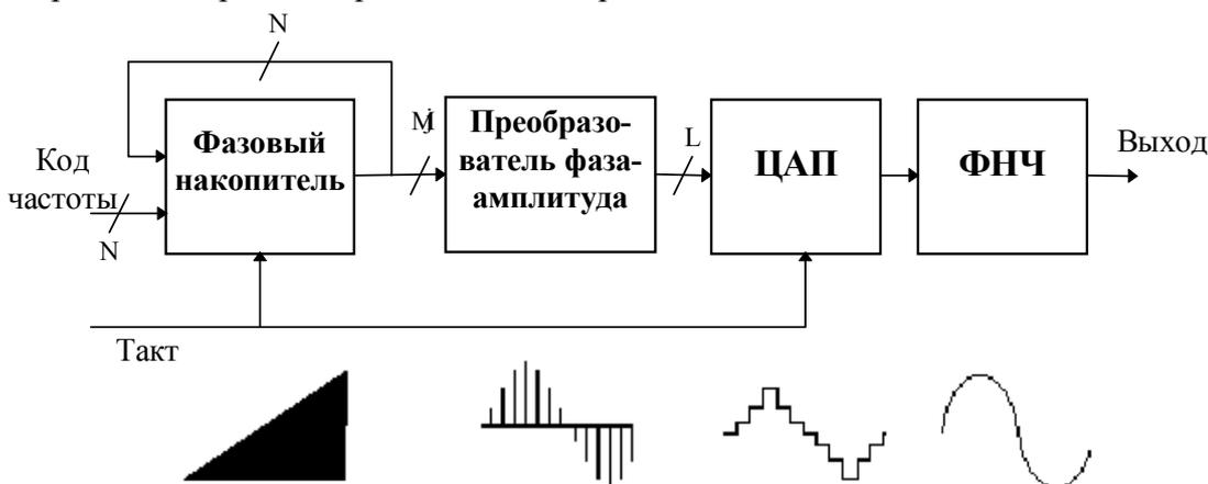
Рис. 1. Структурная схема синтезатора и диаграммы его работы
