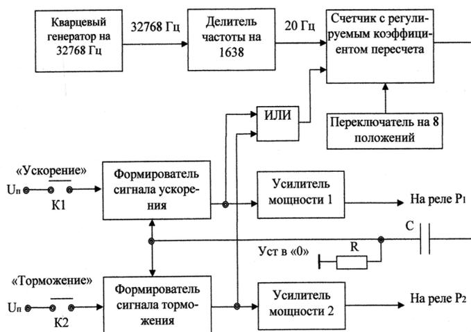
Рис. 4. Структурная схема формирователя временных сигналов (ФВС)
