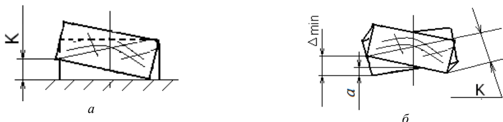
Рис. 4. Совмещенная схема измерения K и a :
