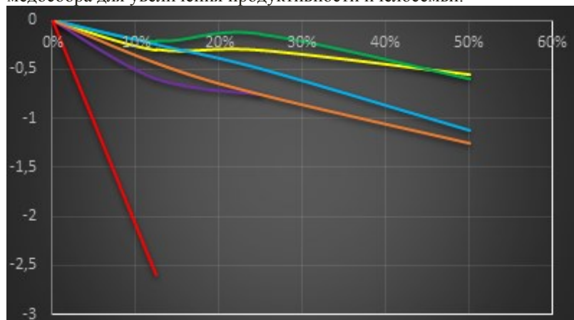
Рисунок 1. Концентрационные зависимости угла поворота плоскости поляризации для соков различных фирм и модельной системы.
