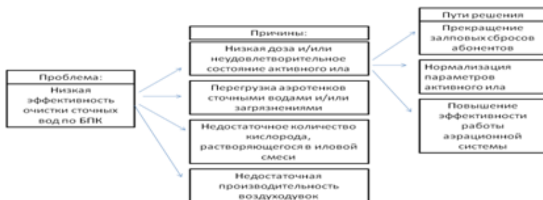
Рис. 1. Блок-схема выбора путей решения по повышению эффективности очистки по БПК
