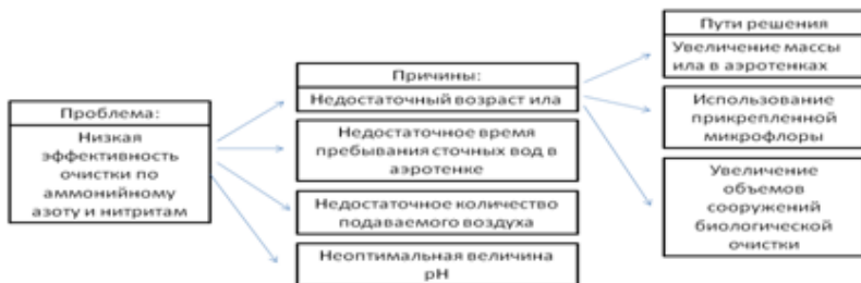
Рис.2. Пути повышения эффективности очистки по азоту аммонийному
