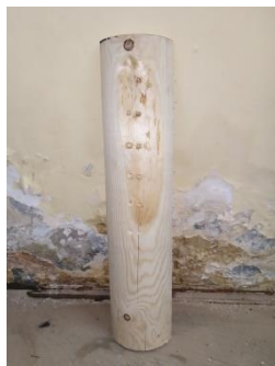
Рисунок 2. Исходные образцы в условиях с повышенной температурой, принудительным увлажнением и отсутствием вентиляции
