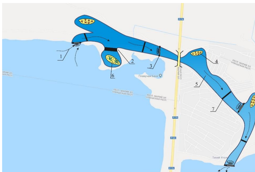
Рис. 1. Рыбоходно-нерестовый канал в створе Чебоксарского гидроузла: 1-привлекающий рыбу поток воды; 2-шлюз-регулятор; 3-регулятор расхода воды; 4-нерестилище для литофильных видов рыб; 5- рыбоходно-нерестовый канал; 6-нерестилище для фитофильных рыб; 7-переливная плотина
