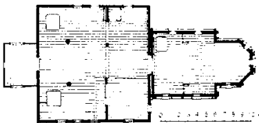
Рисунок 1. Форма храма с образованием зазора между срубами
