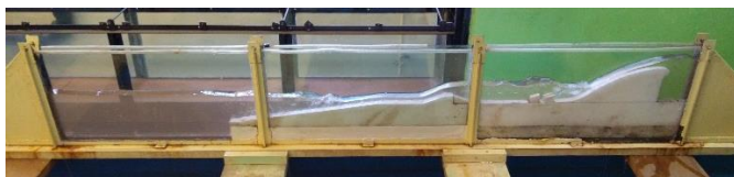
Рис. 1. Маломасштабная модель водосливной плотины Чебоксарского гидроузла с размываемым участком
