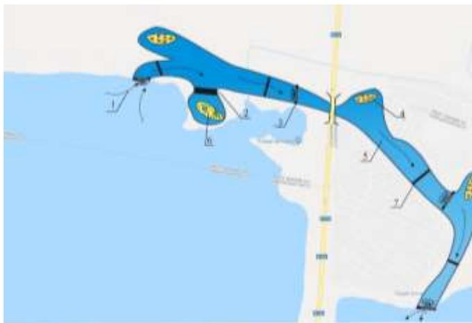
Рисунок 1. Рыбоходно-нерестовый канал в створе Чебоксарского гидроузла: 1-привлекающий рыбу поток воды; 2-шлюз-регулятор; 3-регулятор расхода воды; 4-нерестилище для литофильных видов рыб; 5- рыбоходно-нерестовый канал; 6-нерестилище для фитофильных рыб; 7-переливная плотина
