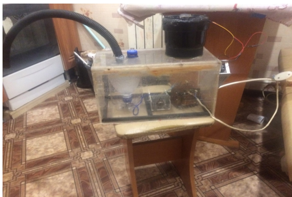
Рис. 1. Конструкция увлажнителя и очистителя воздуха при работ с паяльником
