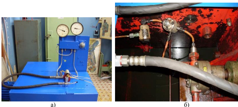
Рис. 3. Установка для испытания рукавов высокого давления а – общий вид; б – вид внутри
