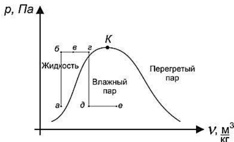
Рис. 3. Диаграмма изменения параметров спиртового топлива при движении от топливного бака до впускного клапана: ab – процесс повышения давления топливным насосом; bg – процесс нагрева топлива перегревателем; gd – процесс впрыска топлива на тарелку впускного клапана; de – подвод теплоты к жидкой сконденсированной на поверхности части топлива от тарелки впускного клапана
