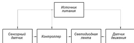
Рисунок 2. Построение структурной схемы
