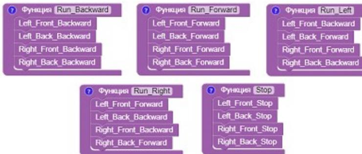
Рисунок 7 - Функции, реализующие перемещение мобильной платформы.
