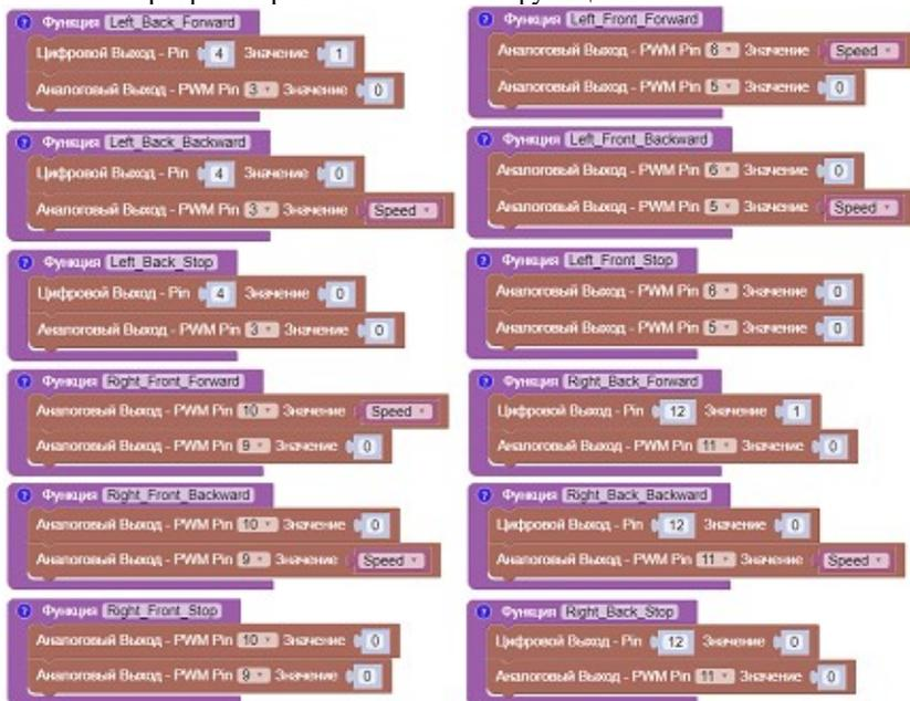
Рисунок 6 - Функции управления направлением вращения моторов
