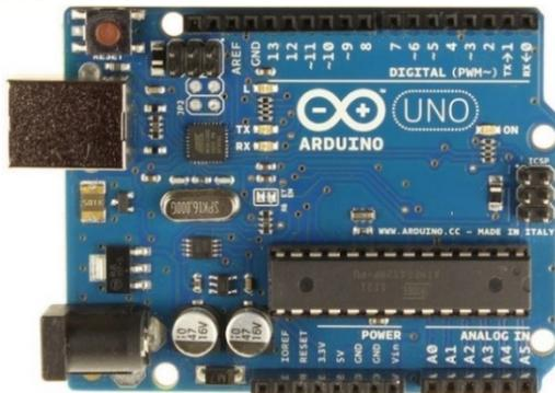
Рисунок 2 – Плата Arduino Uno
