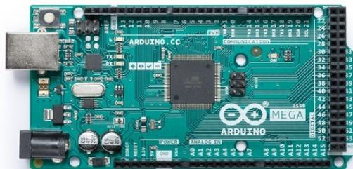
Рисунок 6 – Плата Arduino Mega 2560
