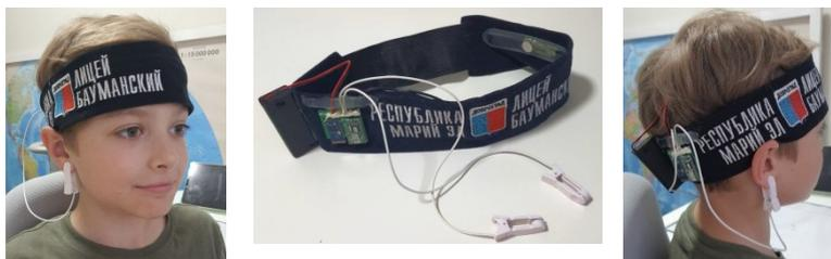
Рис. 3 «Макет устройства для снятия энцефалограммы»
