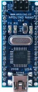
Рисунок 8 – Плата Arduino Nano v2.2
