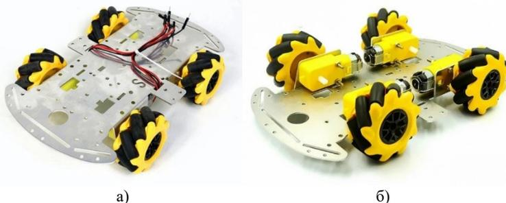
Рисунок 3 - Внешний вид мобильной платформы на четыре меканум-колесах: а) вид сверху; б) вид снизу.
