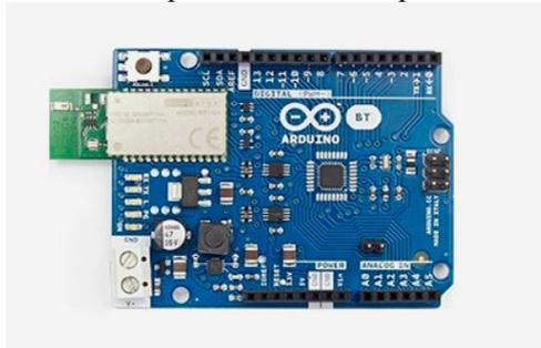
Рисунок 5 - Плата Arduino BT
