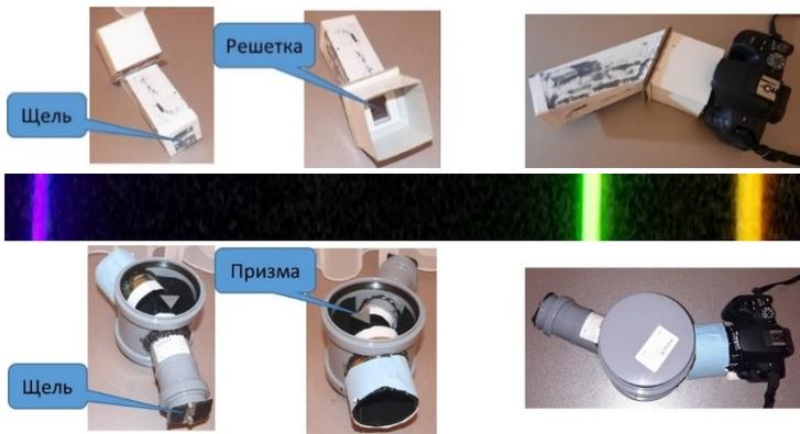
Рисунок 1 - Собранные приборы и полученные с их помощью спектры кварцевой лампы
