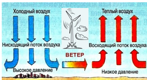
Рисунок 1. Возникновение воздушного потока
