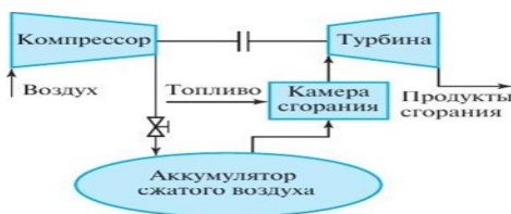
Рисунок 1 – Схема работы генератора на сжатом воздухе
