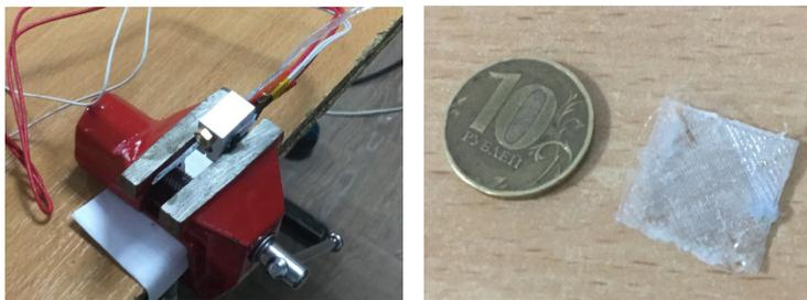
Рис. 1. Установка с модулем нагрева и элемент, полученный из переработанного пластика
