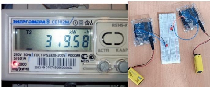
Рис. 1 – Счетчик электроэнергии и собранная схема учета
