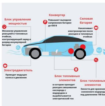
Рис.1. Устройство автомобиля на водородных топливных элементах
