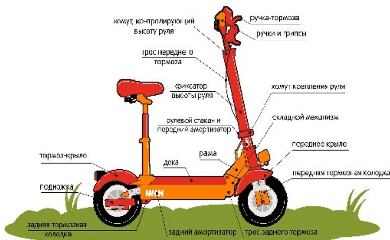
Рис.1. Устройство электросамоката
