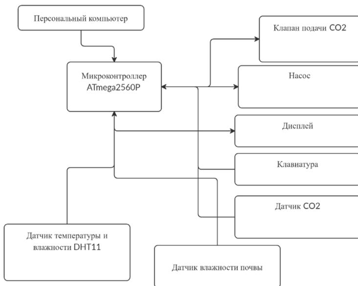
Рис. 1. Структурная схема системы управления камерой дорастивания
