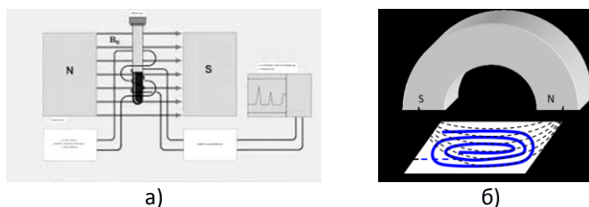
Рис. 1. Изображение приемопередающих катушек: а – классическая в форме соленоида; б – плоская выносная
