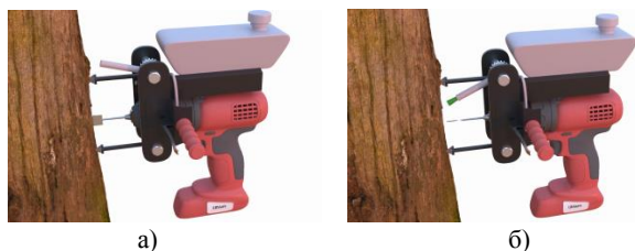
Рис. 2. Инструмент для химического ухода за лесом: а – надрез ствола растущего дерева; б – впрыск химического раствора в надрез ствола растущего дерева
