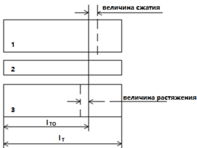
Рис. 1. 1 – твердый сплав; 2 – припой; 3 – сталь (державка)
