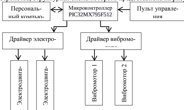
Рисунок. Структурная схема системы управления кресло-платформы для тренажера операторов подвижных объектов
