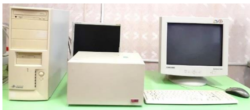
а) б) Рис. 1. а) Внешний вид ЯМР-анализатора, б) окно программы настройки сигнала
