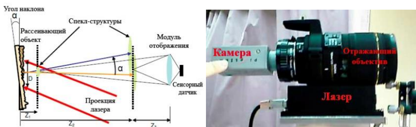
Рис. 1. Схематичное описание системы и пример установки
