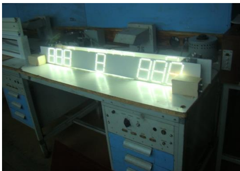
Рис. 1. Цифровой блок индикации спортивного зала ВК ПГТУ, разработанный по первому способу
