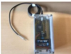
Рис. 1. Передняя панель портативного дозиметра с выходным кабелем
