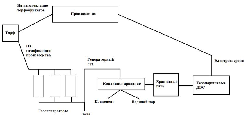
**Технологическая схема получения электроэнергии для торфобрикетного производства на базе газогенераторных установок**
