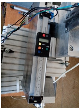
Рис. 3. Установленные на указанные места цифровые линейки
