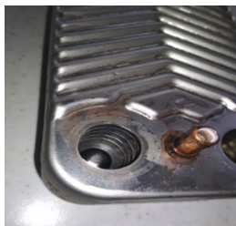
Рис. 2. Внешний вид теплообменника после очистки
