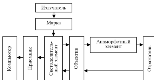
Структурная схема оптико-электронной углоизмерительной системы на основе анаморфотного элемента
