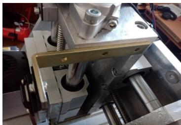
Рис. 2. Кронштейн жесткой конструкции
