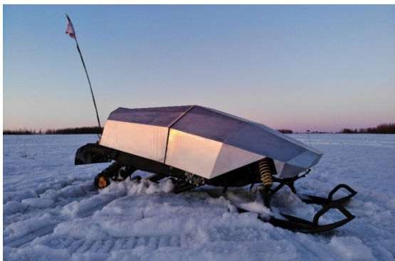
Рис. 3. Опытная действующая модель беспилотной транспортной платформы
