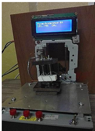
Рис. 5. Опытный образец установки для измерения удельного сопротивления
