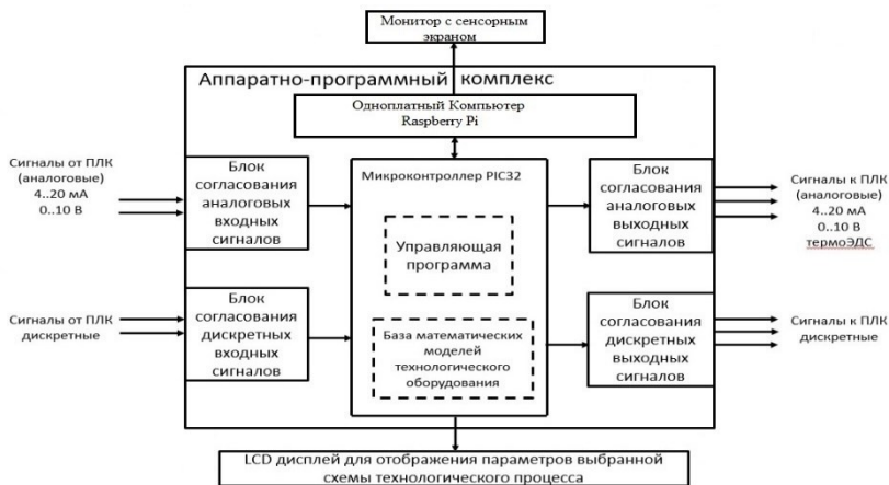
Рисунок 1. Структурная схема аппаратно-программного комплекса симуляции задач управления технологическим оборудованием
