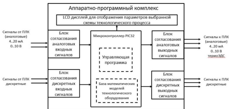
Рис. 1. Структурная схема аппаратно-программного комплекса симуляции задач управления технологическим оборудованием
