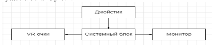
Рис. 1. Структурная схема для определения точности восприятия скорости
