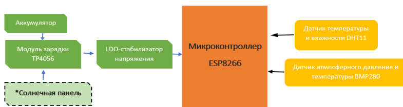
Рис. 1 – Структурная схема метеостанции
