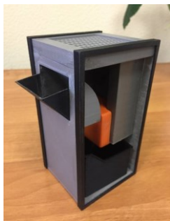
Рис. 2. Опытные образцы «умной урны»: а) модель, распечатанная на 3D – принтере; б) модель, изготовленная в мастерской колледжа
