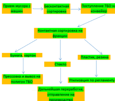
Рис. 3. Схема технического процесса мусоросортировочного завода г. Йошкар-Ола
