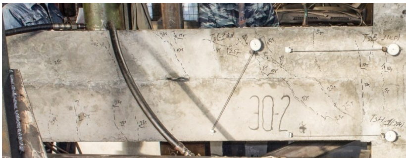
Рис. 2. Экспериментальный образец консольной балки в предельном состоянии.
