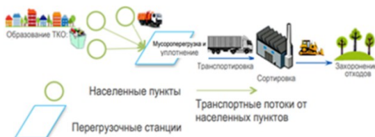
Рис. 1. Интегрированная схема сбора и утилизации ТКО в республике Марий Эл
