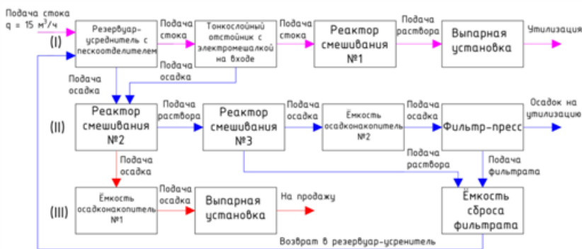
Рис.1. Схема процессов нейтрализации цианистых соединений в сточных водах с выделением осадка
