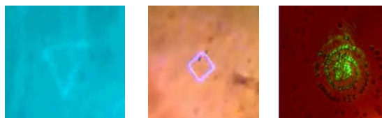
Рис. 1а. Сферические частицы латекса диаметром 1.2 мкм перемещаются по траектории, заданной распределением интенсивности светового поля: вдоль границы треугольника, квадрата, спирали Архимеда
