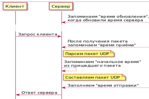
Рис. 2. Диаграмма последовательности протокола NTP
