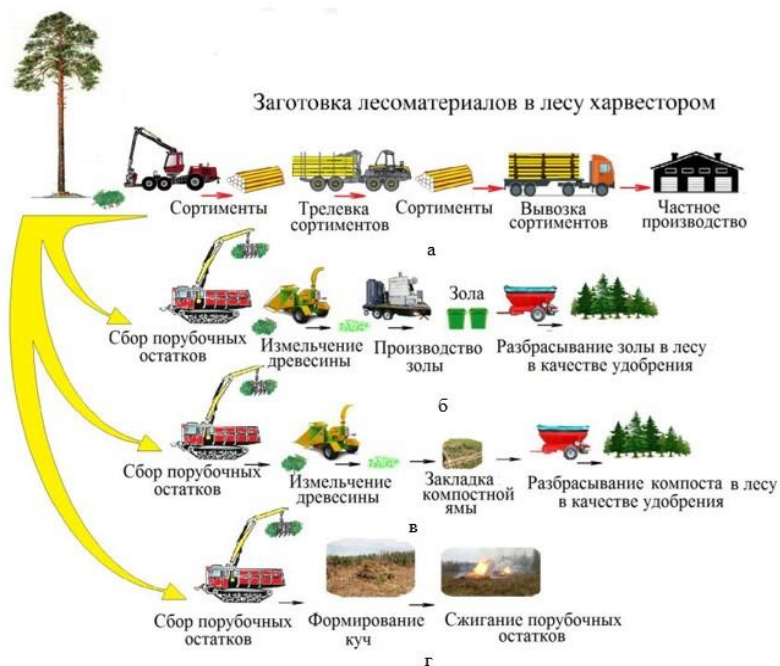
Рис. 1. Заготовка лесоматериалов харвестором:
