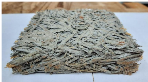
Рис 3. Образец для определения плотности и водопоглощения
