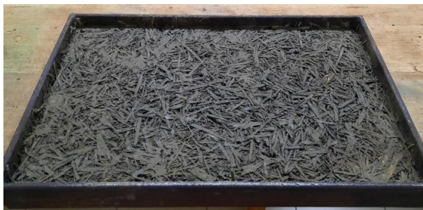
Рис. 2. Цементная плита на основе отходов оцилиндровки бревен
