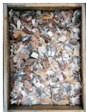
Рис. 1. Измельченная береста в форме для прессования
