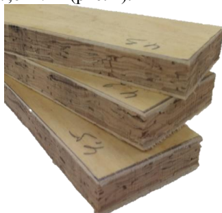
Рис. 2. Образцы плит из бересты с внешними слоями из шпона
