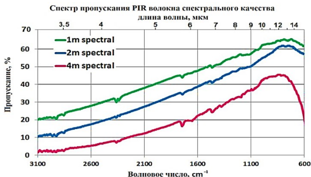
Рис. 2. Спектр пропускания PIR световодов
