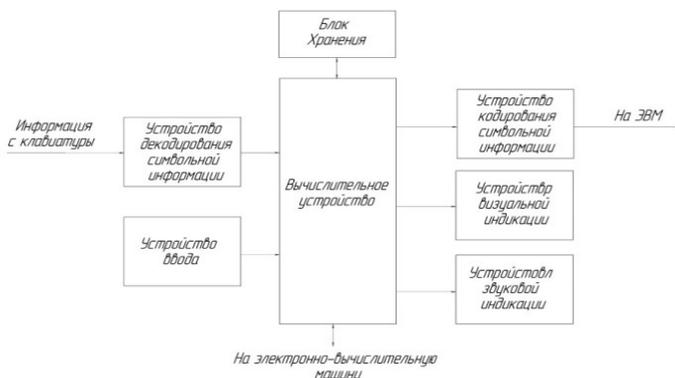
**Рис. 1. Аппаратно-программный комплекс для определения функционального состояния человека**
