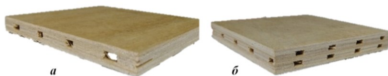
Рис. 1. Конструкции фанерных панелей: а – фанерная панель с одним слоем реек; б – конструкция фанерной панели с тремя слоями реек
