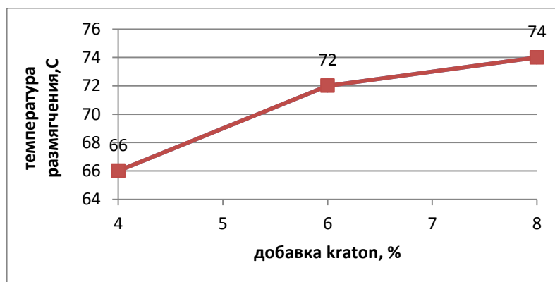
Рис. 1. График зависимости изменения температуры размягчения от расхода добавки СБС- Кратон в вязкий битум БНД 60/90
