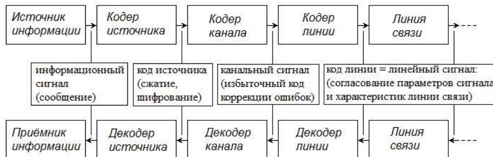
Рис. 1. Структура кабельной цифровой системы передачи и схема преобразования сигналов в ней (в скобках указаны функции сигналов различных уровней)
