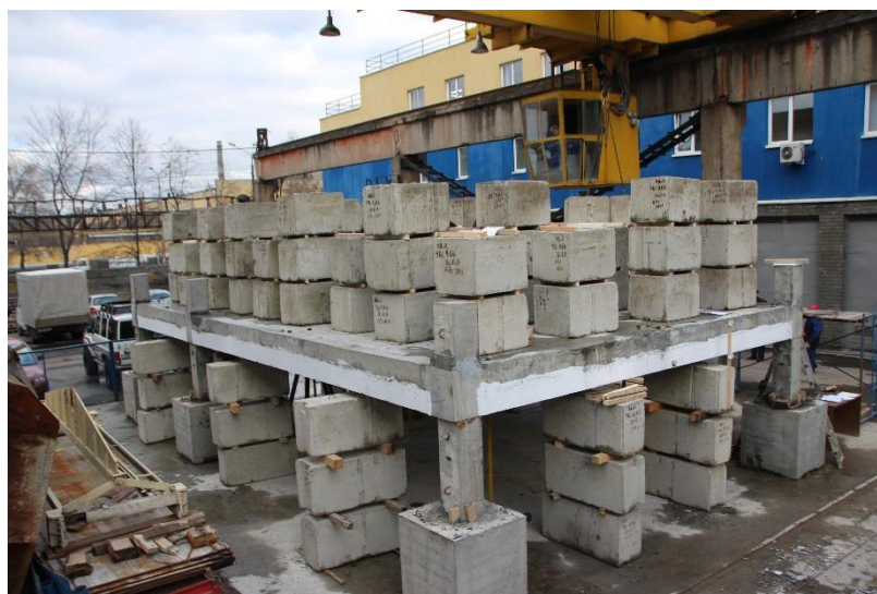
Рис. 4. Общий вид испытания фрагмента каркаса
