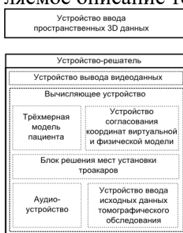
Рис. 1. Структурная схема АПК
