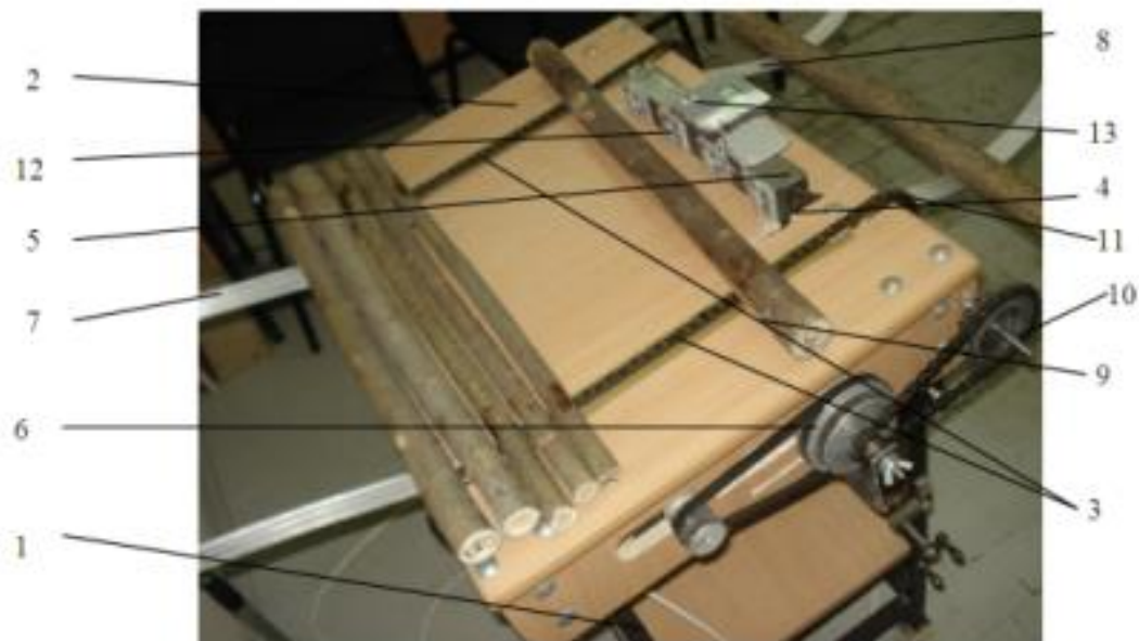
Рис. 1. Модельная установка: 1 – рама (основание); 2 – рабочий стол; 3 – цепь поперечного транспортера; 4 – отсекатель; 5 – балка; 6 – блок приводных шкивов; 7 – наклонная; 8 – приемный лоток; 9 – модельные бревна; 10 – вал; 11 – звездочка; 12 – тензометрический датчик; 13 – дисплей
