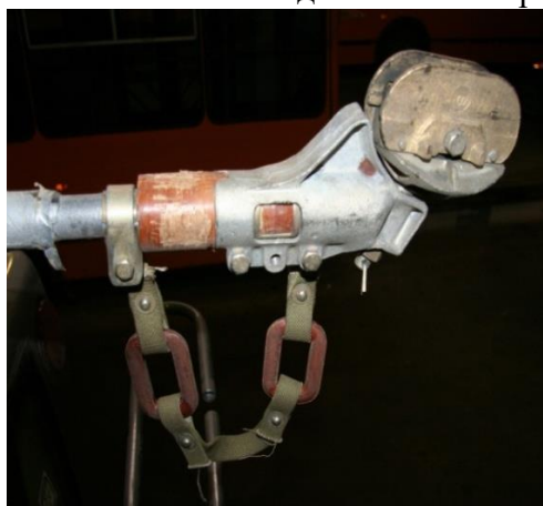
Рис.1. Токосъемный узел троллейбуса
