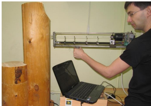
Рис.2. Лабораторная экспериментальная установка мобильного устройства для диагностики состояния древесины сверлением, патент РФ №95128
