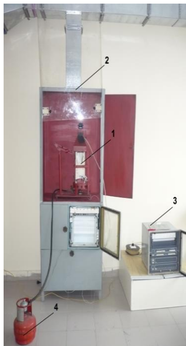
Рис. 1. Внешний вид лабораторной установки: 1 – прибор ОТМ; 2 – вытяжной шкаф; 3 – устройство контроля и регистрации данных; 4 – газовый баллон
