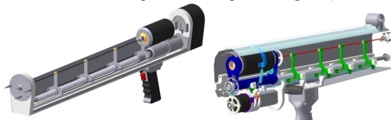
Рис.1. Модели устройств для измерения сопротивления сверлению по патентам РФ № 95128 (слева) и № 2448811 (справа)
