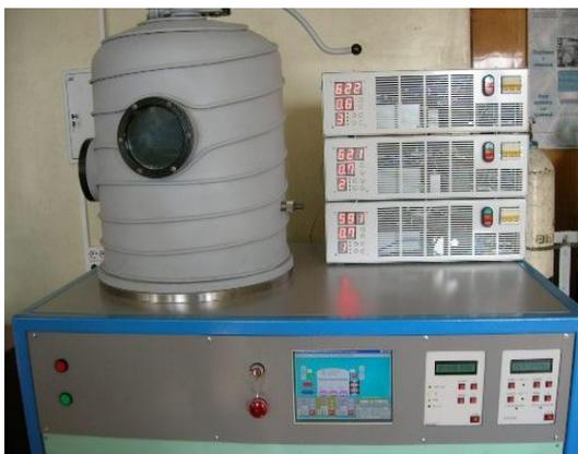
Установка магнетронного распыления
