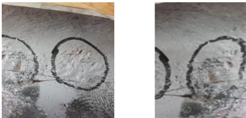
Рис. 1. Фотографии вырезок трубы с трещинами различной ориентации, фиксированными методом цветной дефектоскопии с использованием пенетрантов Шервин
