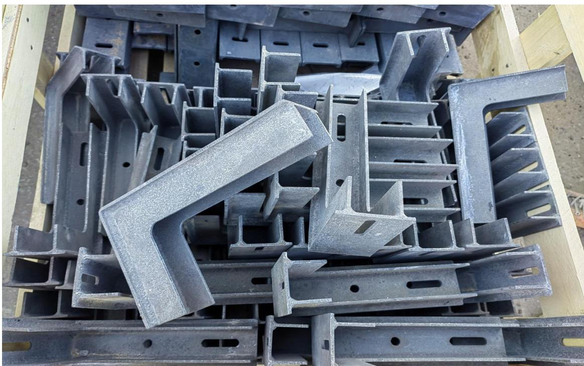
Рис. 1. Узловые крепления каркасов НПС после термодиффузионного цинкования
