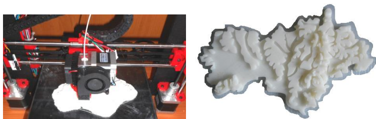
Рис. 2. 3D-печать (слева) и изготовленная рельефная карта Марий Эл (справа)
