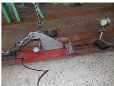
Рисунок 1 – Вид кронштейна КН-U на испытательном стенде
