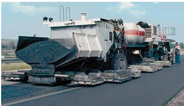
**Рисунок 2 – Состав машин при производстве горячей регенерации асфальтобетонного покрытия**
