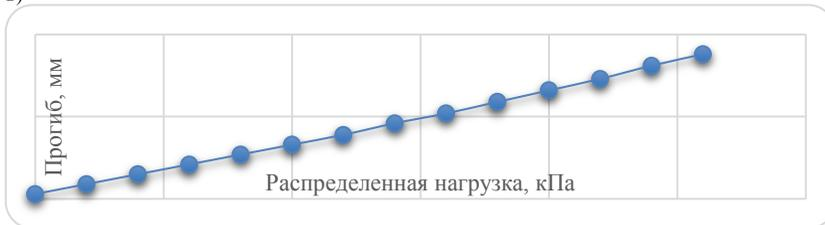
Схема установки прогибомеров (Т) на опытной конструкции (а), график прогибов в центре плиты от нагрузки (б), результаты вычислений программом комплексе Eurosoft StarkES (в).
