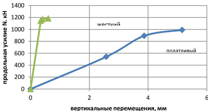
Перемещения в стыке при жестком и податливом заземлении соответственно
