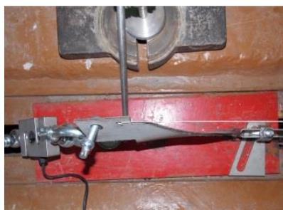
Рисунок 2 – Вид кронштейна КН-U после разрушения
