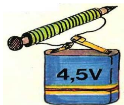
Рис. 3. Катушка с сердечником
