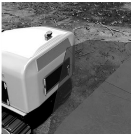
Рис. 4. «Слепая зона», охватываемая ультразвуковым датчиком
