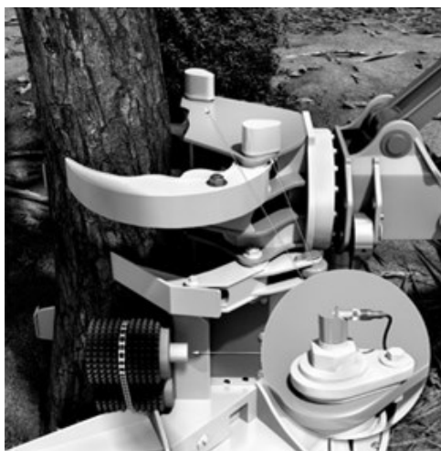
Рис. 1. Измерение ствола дерева посредством энкодеров, установленных в харвестерной головке
