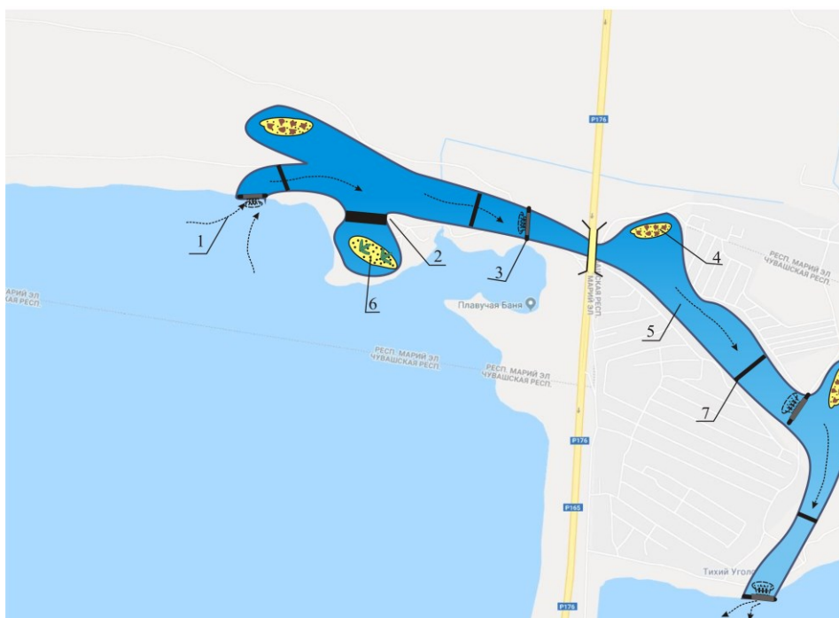
Рис. 1. Рыбоходно-нерестовый канал в створе Чебоксарского гидроузла:
