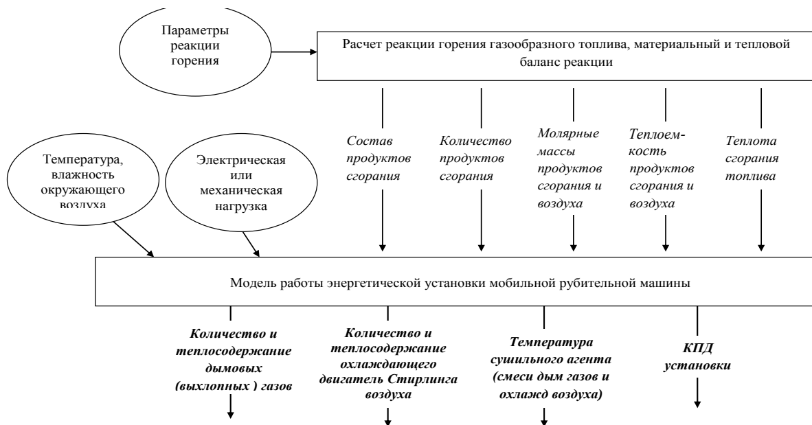
Рисунок 1 – Блок-схема вычислительного эксперимента по определению качественных и количественных параметров теплоносителя – смеси дымовых газов и охлаждающего двигателя воздуха
